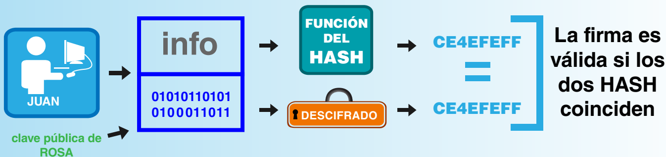
Figura 3.4. Proceso de Validación de la Firma Electrónica. Fuente (SUSCERTE, 2009)
